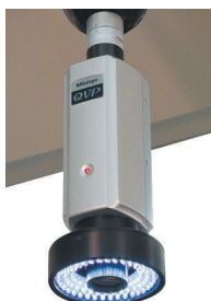
QVP (Quick Vision Probe - Kamerová snímací sonda)
