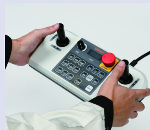
Volitelný joystick-box M2 s potenciometrem pro nastavení rychlosti
