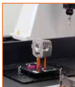
K551218: Příklad aplikácie upínacieho paletového systému
