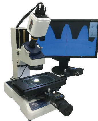
Měřicí mikroskop TM-1005B s volitelným LED prstencovým osvětlením (63AAA001) a digitální HDMI USB kamerou sadou (63AAA353)
