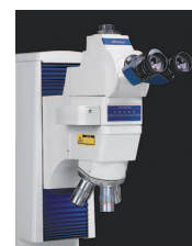
Optický tubus automatického zaostřování laserem.
