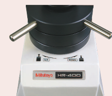
HR-400 Automatická brzda předběžného zkušebního zatížení
